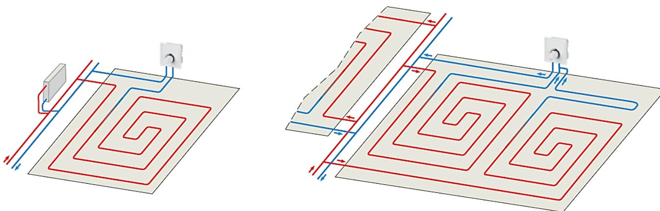
Система напольного отопления без центрального коллектора, например, с двумя отопительными контурами одинаковой длины на каждое помещение и блоком Multibox Mini RTL (см. раздел 5.1. Указания к подбору).
